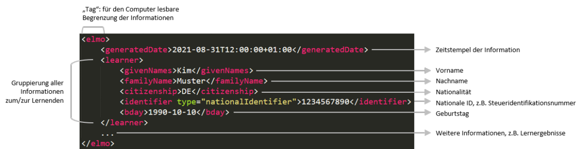
Abbildung 6: Maschinenlesbare ELMO-Daten mit Informationen in weißer Schrift und für den Computer erforderliche Strukturen in bunter Schrift.
